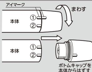
2: 本体のスイッチOFFボタンを押し、スイッチがOFFであることを確認してから単4アルカリ乾電池を図のように本体にいます。
